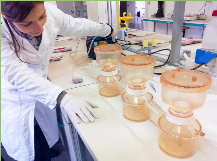
Apparato filtrante collegato a pompa
